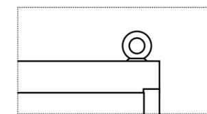
Des crochets de transport fixés sur l'ensemble facilitent le déplacement et l'installation en tout lieu.
